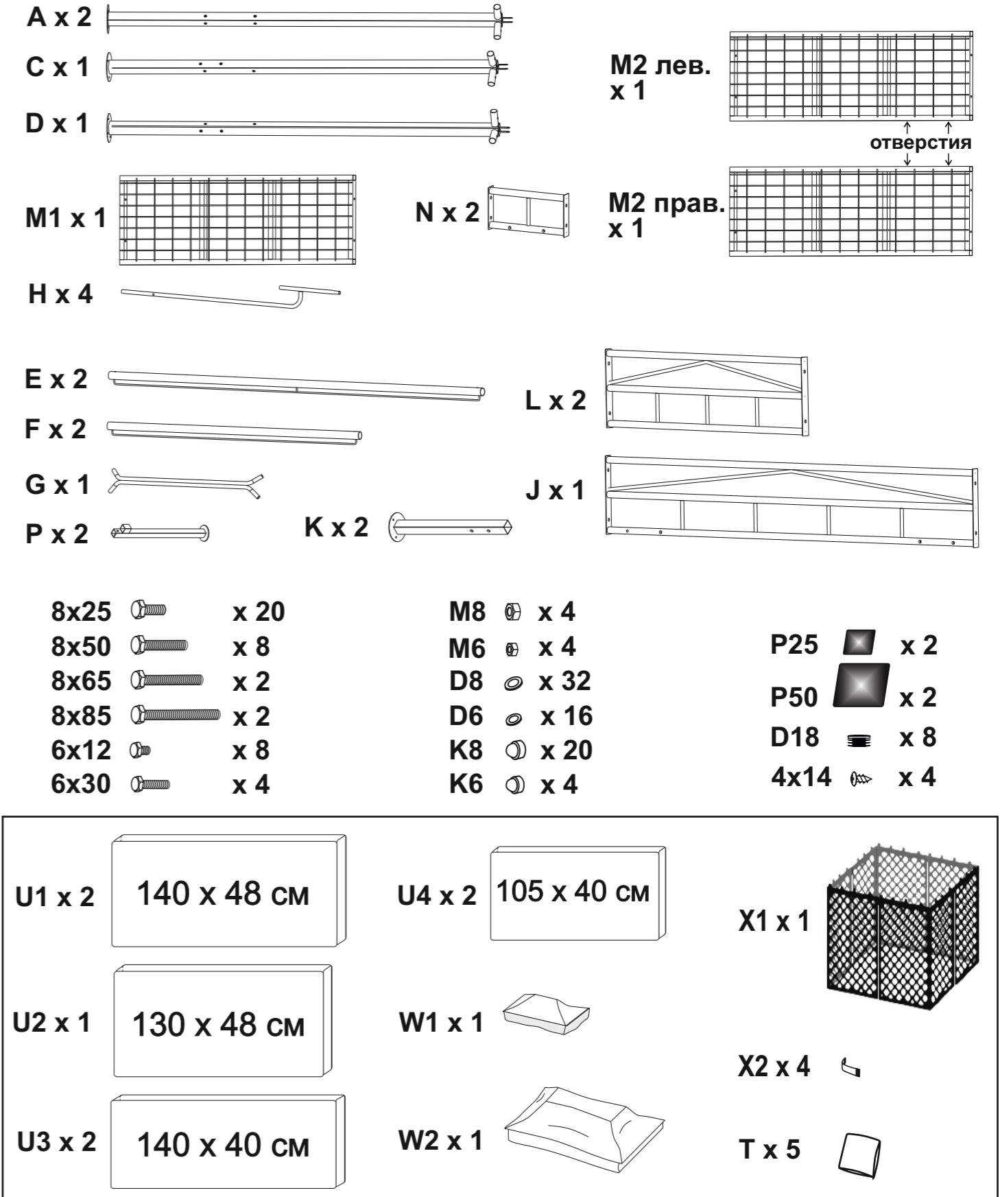
ВНИМАНИЕ! Предварительную сборку произвести без затяжки резьбовых соединений. Затяжку произвести, удостоверившись в правильности сборки. Порядок сборки указан цифрами в кружках.
